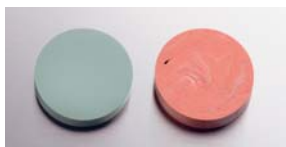
Obr. 29: Srovnání kvality směsi připravené z Express™ XT Penta™ Putty v Pentamixu™ (vlevo) a ručně míchané směsi materiálu Express™ STD Putty (vpravo).
