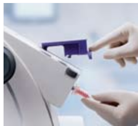
Ľahko upevniteľné miešacie kanyly bez otvorenia krytu prístroja
